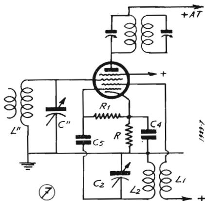
zione della stazione che si vuole ricevere, è facile constatare che la corrente anodica della valvola è controllata in effetto non dalla sola griglia pilota, ma anche dal catodo alla cui tensione positiva si aggiunge quella alternata della oscillazione prodotta localmente.
