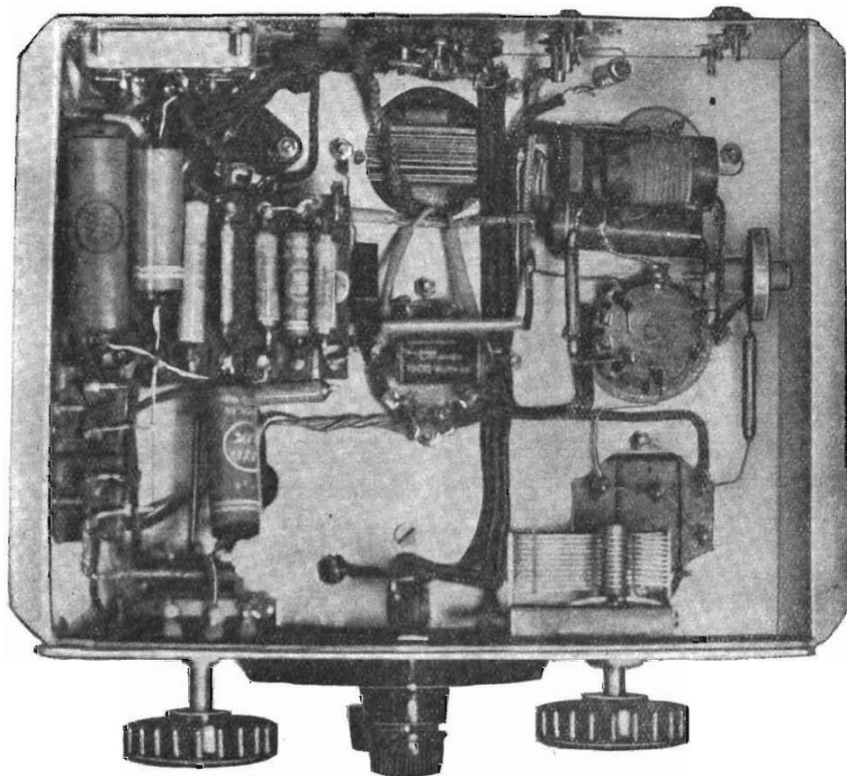
statico per dividere in due parti il ricevitore: in una di queste si trovano tutti gli elementi ad alta frequenza (eccettuato il condensatore variabile di sintonia, che essendo schermato per proprio conto, può essere piazzato in un qualsiasi punto del ricevitore); nell'altra parte invece si trovano tutti gli elementi della bassa frequenza e dell'alimentazione.
