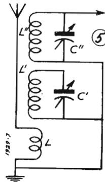
La fig. 5 mostra un altro circuito del genere nel quale il trasferimento di energia si compie per via magnetica direttamente da una induttanza all'altra.
