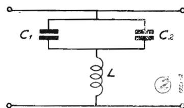
rante la misura. La bobina quindi è misurata, quando è in parte accordata da questa capacità addizionale. Le condizioni di bilanciamento della resistenza sono variate poiché allora la bobina presenta una più elevata resistenza apparente. La reattanza invece non viene variata eccetto che nel caso in cui la capacità parassita diminuisca di quanto era necessario avere nelle capacità di sintonia ed aumenti così il valore che si può ottenere per la capacità minima di accordo.
