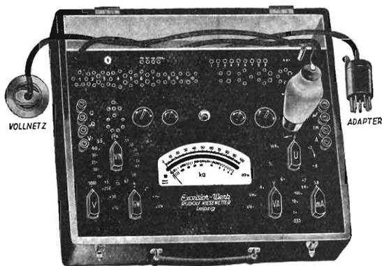
Analizzatore Provavole "KATHOMETER,,
