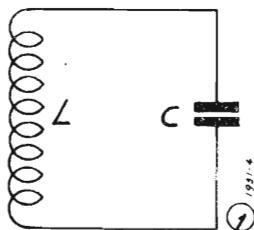
po, tempo che sarà tanto più lungo quanto più grande sarà il valore dell'induttanza e della capacità. Possiamo perciò variare il numero delle oscillazioni prodotte in un secondo sia variando il valore dell'induttanza sia variando quello della capacità od anche variando ambedue.
