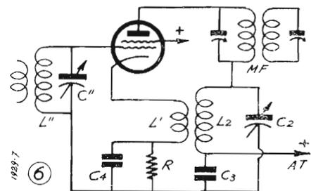
valvole amplificatrici di media frequenza dei trasformatori con primario e secondario entrambi accordati.
