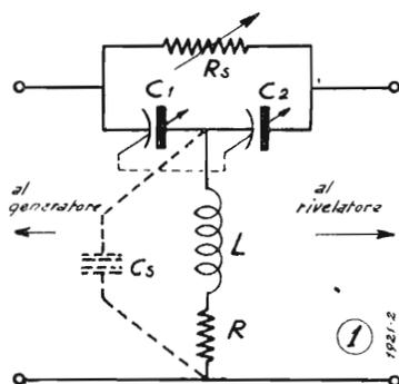
Le letture sono del tutto indipendenti dall'impedenza sia del generatore sia del rivelatore. Inoltre la bassa impedenza del circuito offre il vantaggio di rendere trascurabili la capacità tra ingresso e uscita e la capacità del corpo dell'operatore.
