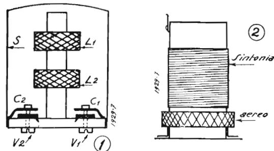
La fig. 1 mostra un esempio di realizzazione industriale di due circuiti oscillanti accoppiati per frequenza intermedia.
