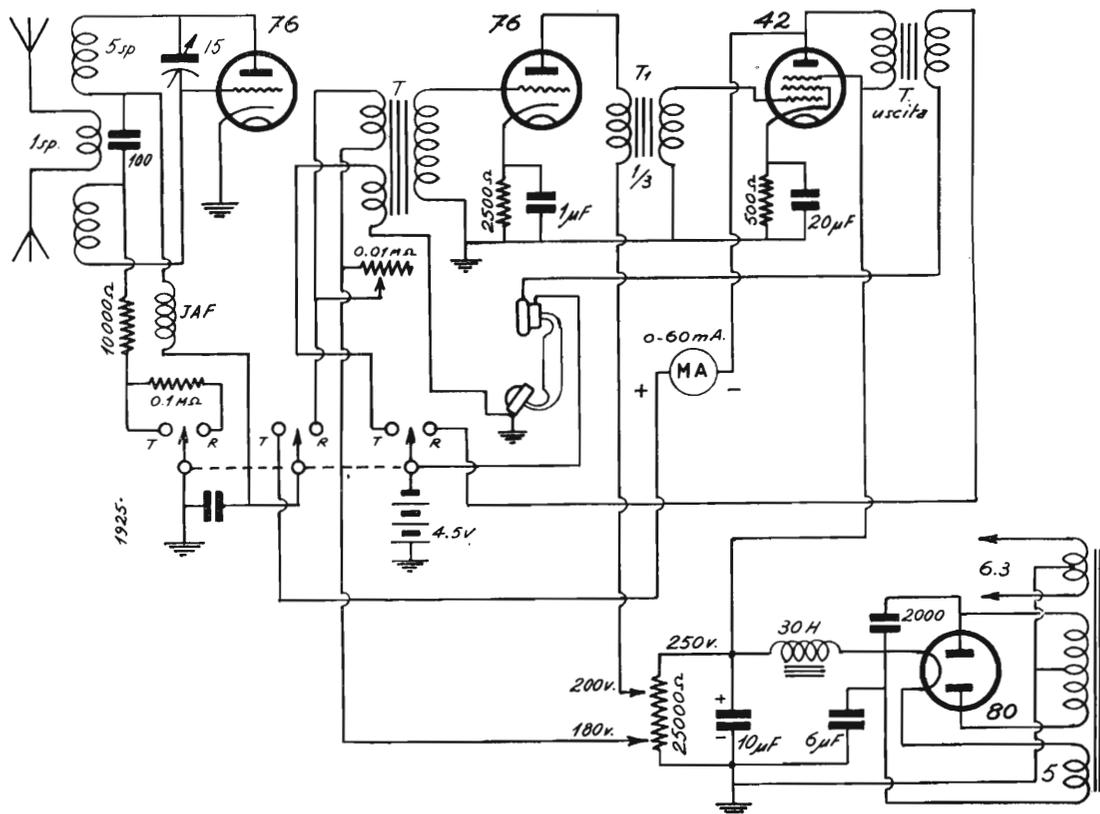
per-rigenerazione in ricezione ed oscillatrice in trasmissione, una pre-amplificatrice di bassa e pre-modulatrice anch'essa di tipo 76, una modulatrice e valvola finale 42, una raddrizzatrice 80. Questo circuito è di facilissima costruzione e può essere montato su di un comune chassis metallico, racchiudente eventualmente anche l'alimentatore anodico, sebbene ciò non sia sempre consigliabile.
