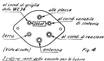
dotato di 6 piedini disposti come nelle valvole americane: per le bobine ad onde medie e ad onde lunghe il fissaggio viene eseguito, come è indicato in fig. 5 a mezzo di una basetta di bachelite, a due alberelli in ottone, i quali tra l'altro servono anche al fissaggio dello schermo di cui sono corredate queste due bobine. Lo schermo si rende necessario sia per preservare la bobina, sia per evitare la captazione diretta di segnali.
