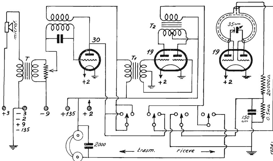
vuta all'oscillatore in opposizione, modulazione al 100 % con valvola 19 in classe B e con valvola 30 pre-amplificatrice. Questa valvola ha due funzioni distinte. Serve a produrre i battimenti inaudibili di super-rigenerazione, ossia la frequenza di interruzione in ricezione e modula lo stadio in opposizione di classe B in trasmissione.
