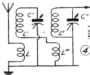
capacità e doppia reattanza induttiva, avrà cioè la stessa frequenza di risonanza dei singoli circuiti oscillanti componenti.
